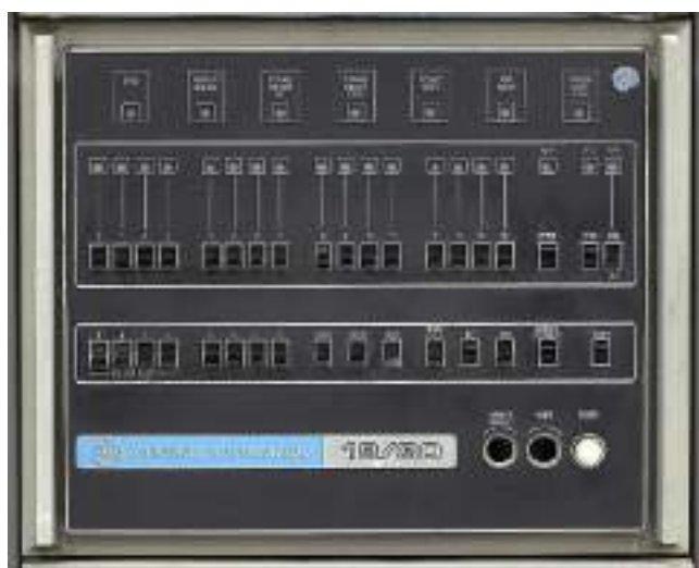
Panel de control del miniordenador GA 18/30, clónico del IBM 1130. Era un equipo extraordinario
