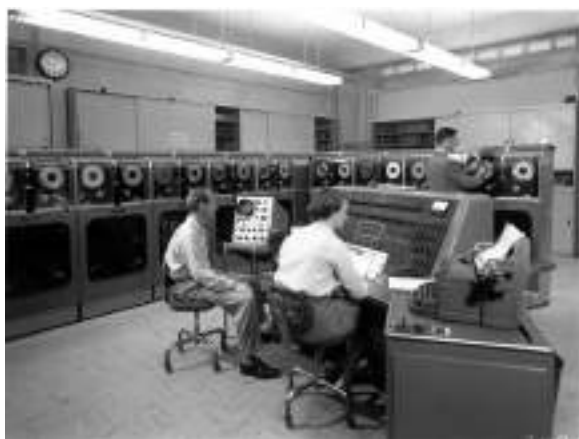
UNIVAC-I, primer ordenador comercial del Mundo (1951): 5200 válvulas, 13 Tm, 125 Kw
